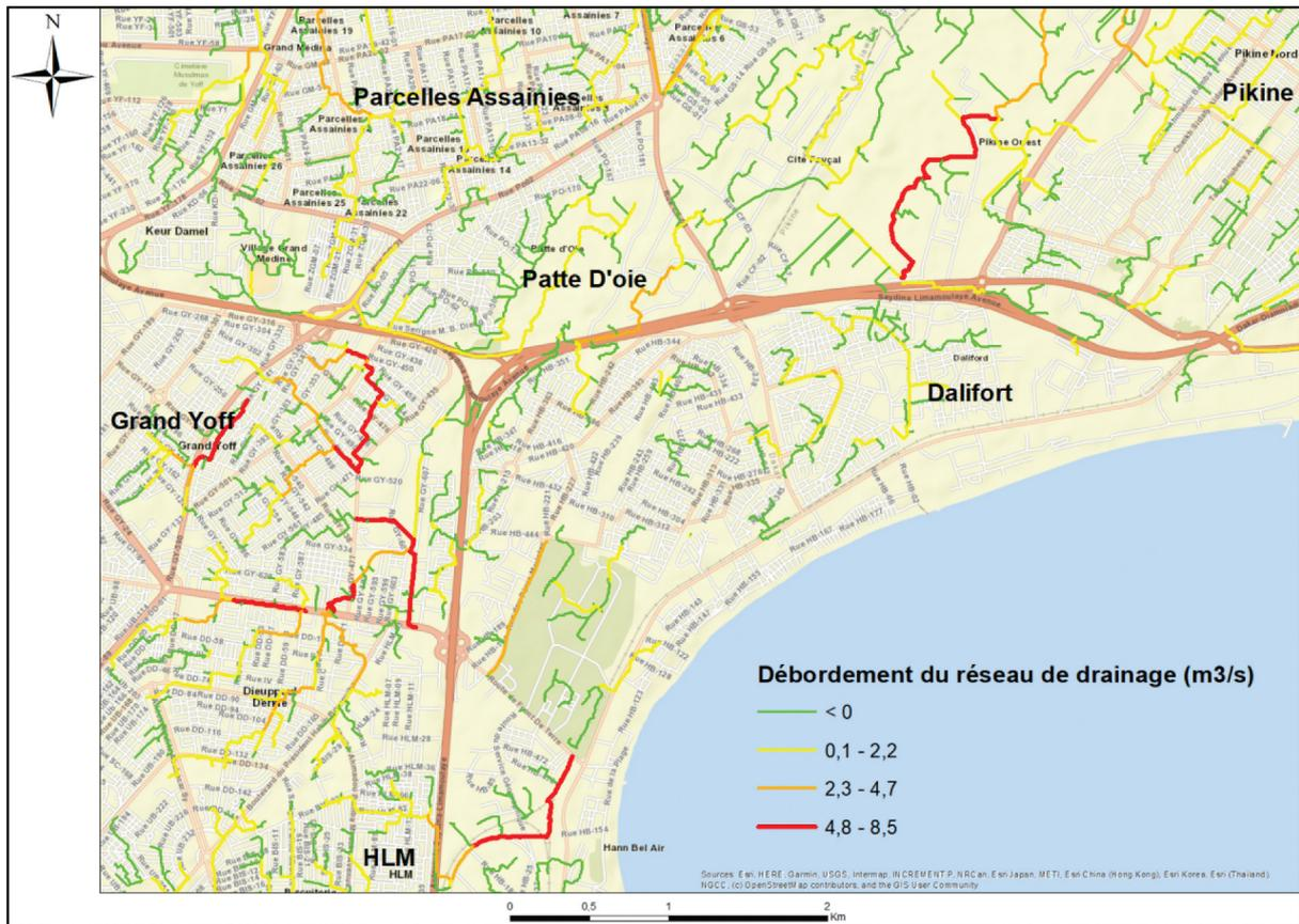
**Figure 3.** Représentation en codes couleurs des points de débordement du réseau de drainage par niveau d'importance : Vert = pas de débordement; Jaune – Orange et Rouge = débordement avec différents seuils.
